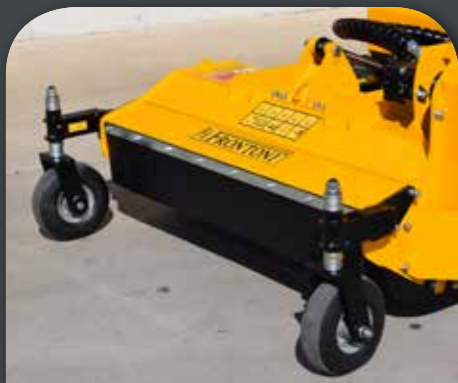
Kit ruote per il lavoro nei parchi Kit wheels to install on the flail head in the parks Kit roues à appliquer à la tête de broyage dans les parcs
